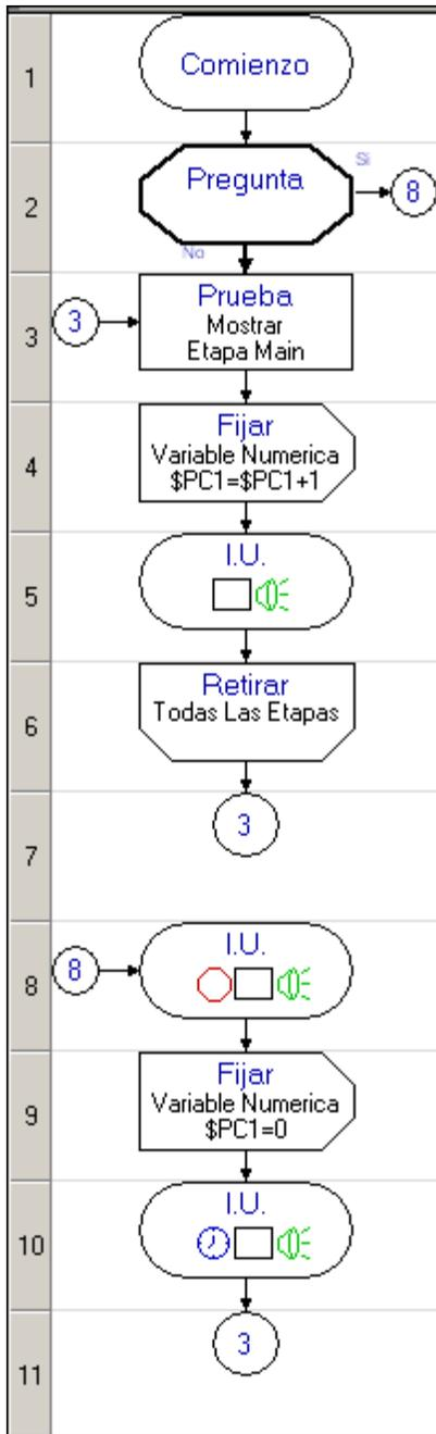
← Este elemento de Pregunta ha sido configurado para solicitar al Operador si el contador debería ser reiniciado. Si el Operador indica que Si, la ejecución salta a celda 8. Si el Operador indica que No, la ejecución continua a celda 3
