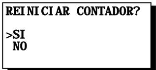
La sección Dependiendo de la Respuesta Pasar A:, es configurada para continuar en la celda 9 si el operador selecciona “SI”. Si el operador selecciona “NO”, provocara un salto a la celda 3.
