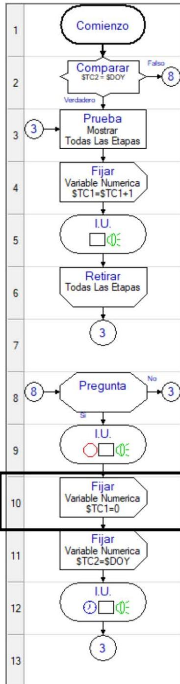
Esta celda Fijar Variable Numérica es configurada para fijar la variable numérica \$TC1 a cero.
